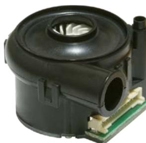
本製品は日本電産コパル電子の独自技術である空気動圧軸受を採用しています。空気動圧軸受は、空気圧の力で軸受を浮上させ、完全非接触の状態では回転することで、優れた高速回転や長寿命、低振動の特性を実現しています。
